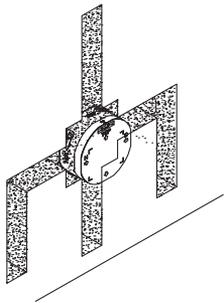
Еще раз проверьте, что все трубы подключены правильно, и нет утечки, а затем используйте цемент для покрытия стены.
