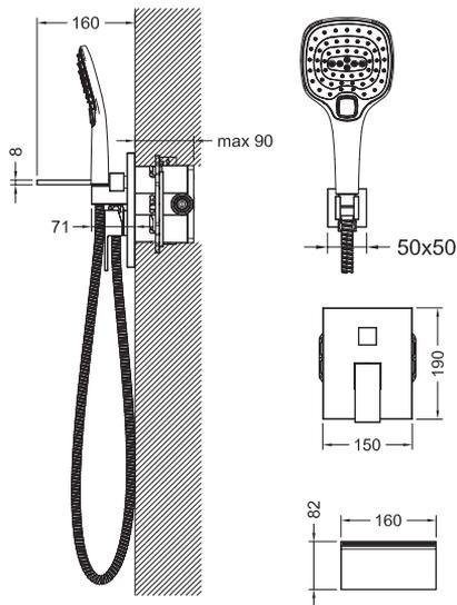
Смеситель устанавливается на глубину 65-90 мм от внешней поверхности стены.
