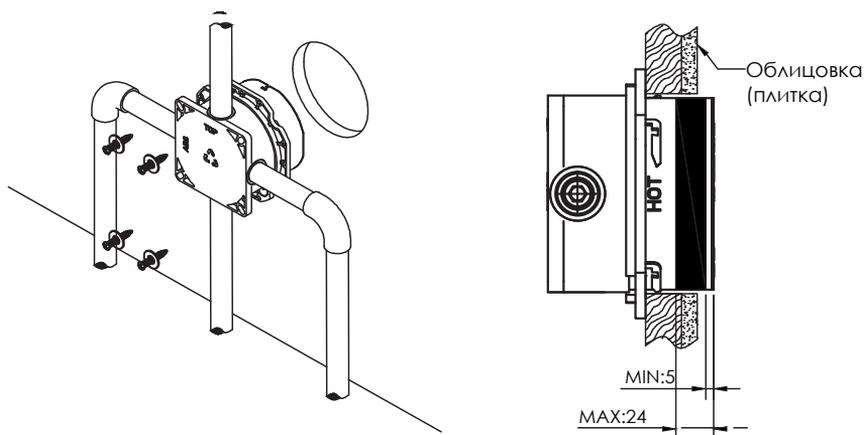
Просверлите отверстие в полой стене соответствующее диаметру монтажной коробки в желаемом месте установки смесителя.
