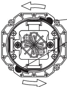
Примечание: крепежные пластины предназначены только для полых стен, если они установлены на капитальной стене, тогда необходимо снять их.
