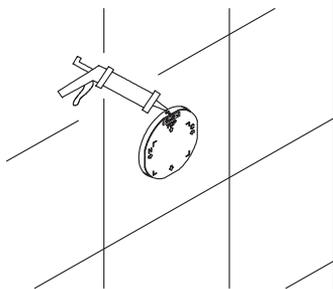
Нанесите водонепроницаемый герметик, в месте соединения облицовки с монтажной коробкой.
