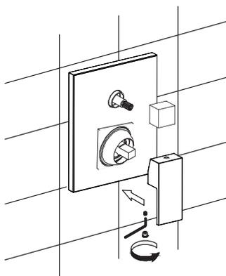
Снимите защитную крышку и установите декоративную накладку.
