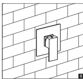
После укладки облицовки (плитки) наденьте декоративный отражатель на корпус смесителя, прикрутите ручку смесителя с помощью шестигранного ключа, соедините шланг душа с отводом из стены и прикрутите к шлангу гигиеническую лейку.
